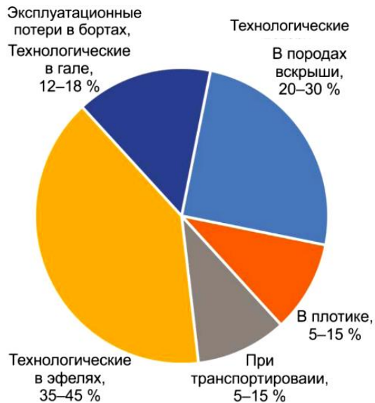
Рис. 4. Структура формирования техногенных запасов при первичной отработке россыпи открытым раздельным способом
