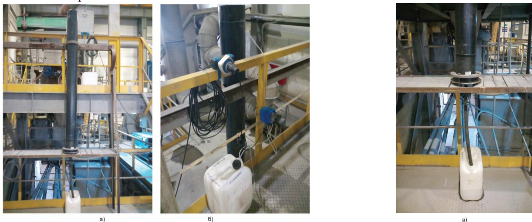
Рис. 2. Установка для тестирования (перколяционная колонна) шихты проб ТП-1-22-3 и ТП-2-22-Х: а) общий вид колонны; б) система подачи выщелачивающего раствора; в) система сбора продуктивного раствора / Fig. 2. Installation for testing (percolation column) of TP sample charge-1-22- Z and TP-2-22- X: a) general view of the column; b) leaching solution supply system; c) the system of collecting a productive solution
