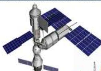
Создание на базе модулей РС МКС российской орбитальной станции
