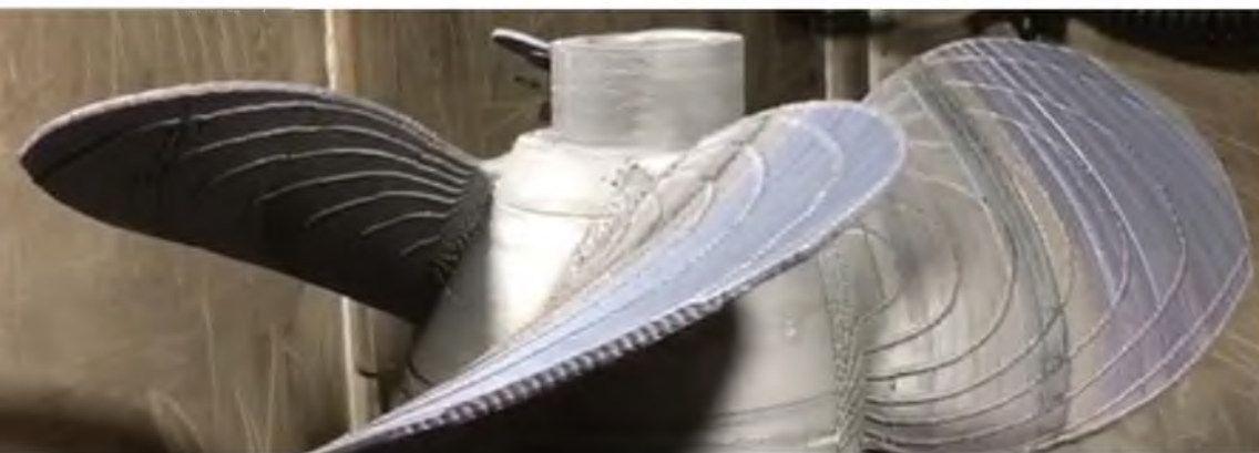
Выращенная заготовка гребного винта для механической обработки
