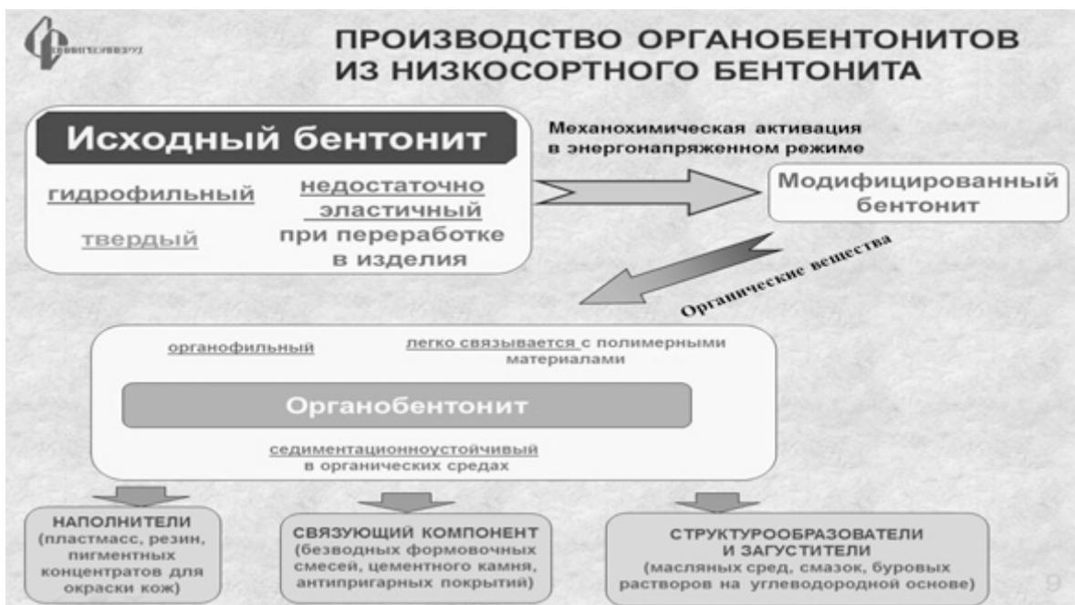
Рис. 8. Производство органобентонитов из низкосортного бентонита
