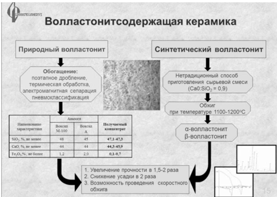
Рис. 13. Волластонитсодержащая керамика
