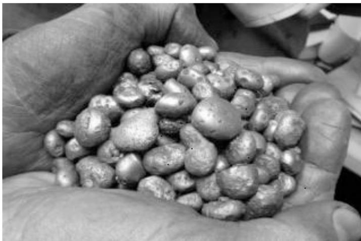
Рис. 3. Железо прямого восстановления, полученное по технологии ITmk3
