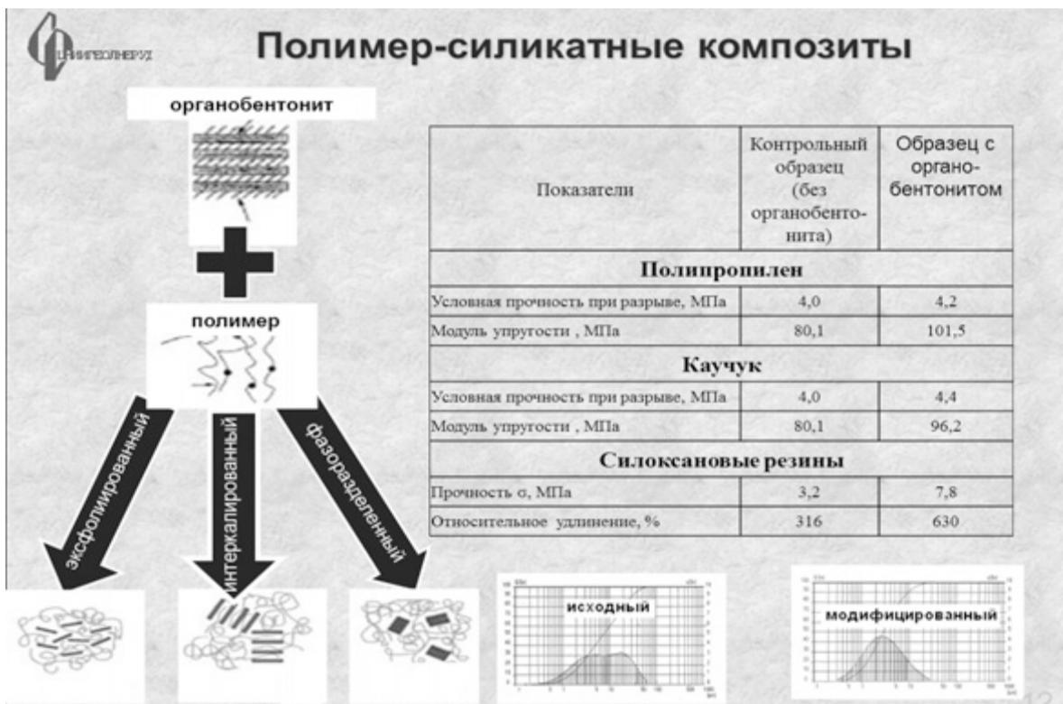
Рис. 10. Полимер-силикатные композиты
