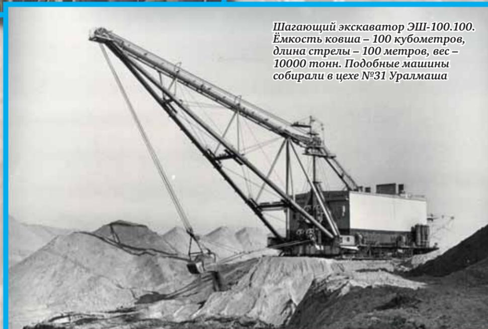
*Шагающий экскаватор ЭШ-100.100. Ёмкость ковша – 100 кубометров, длина стрелы – 100 метров, вес – 10000 тонн. Подобные машины собирали в цехе №31 Уралмаша*
